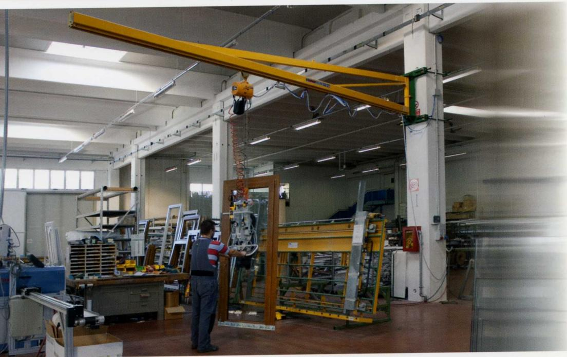
Gru a bandiera a mensola con braccio in profilato a canalina con ventosa tipo GP2RB con rotazione continua ad incrementi di 90° e basculamento 0-90° manuali per la movimentazione degli infissi. FASE1: posizione verticale dell'infisso
