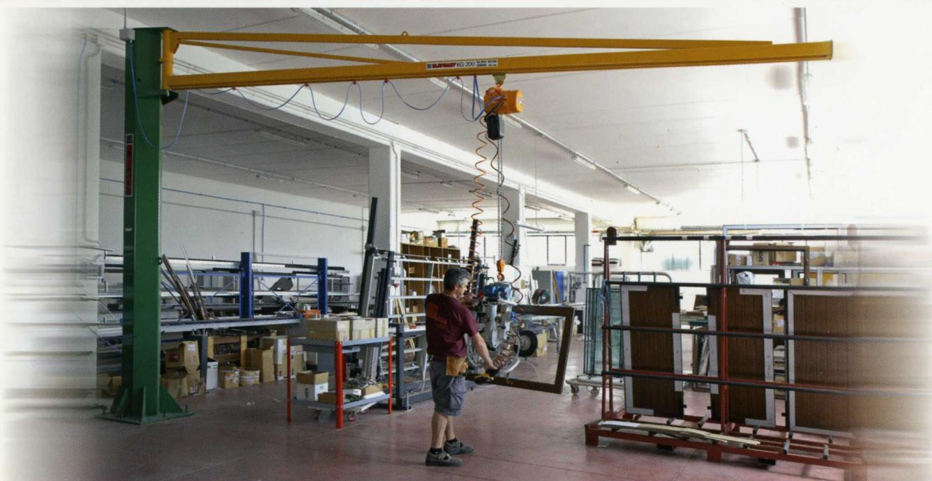
Gru a bandiera a colonna con braccio in profilato a canalina con ventosa tipo GP2RB per la movimentazione degli infissi
