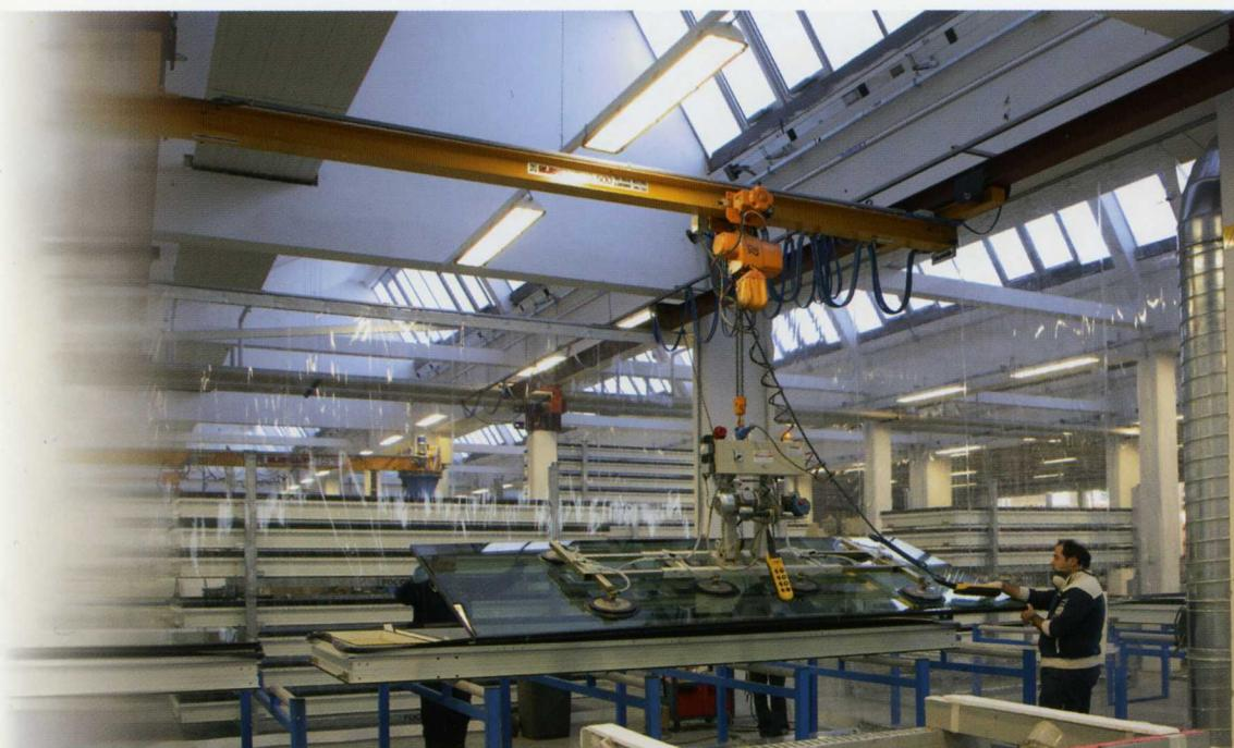
Carroponte elettrico e ventosa con movimenti elettrici tipo GP8REBE con bracci telescopici
