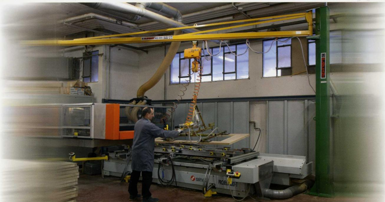
Gru a bandiera a colonna con braccio in profilato a canalina e ventosa tipo PNT4RP per movimentazione delle porte
